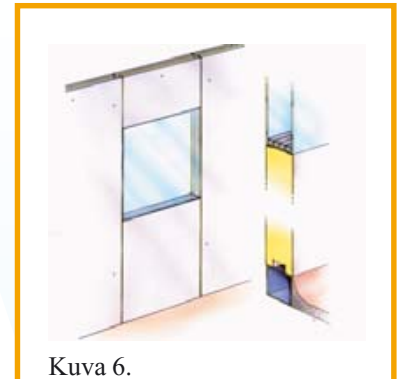
Kuva 6. 65mm:n Farma-mallin ikkunaperiaate ja putkiasennus
